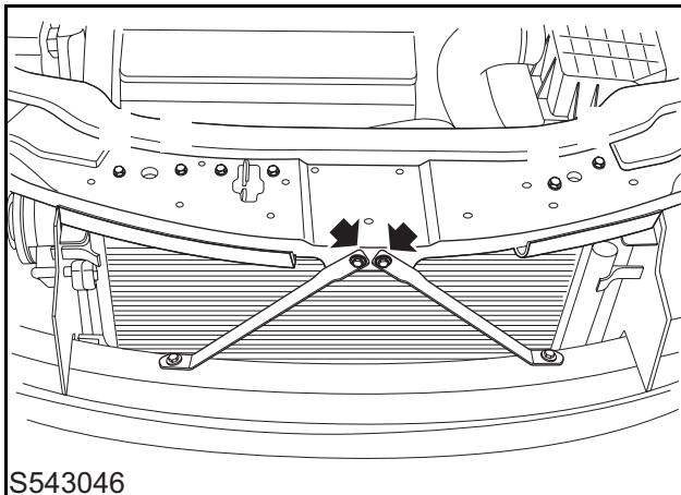
5 拆下水箱上横梁支架上面的 2 个螺栓。
