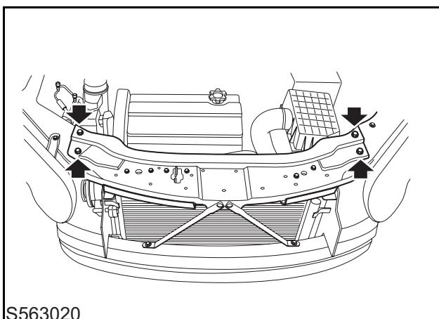
6 拆下 4 个将水箱上横梁固定到车身上的螺栓并移到一边。
