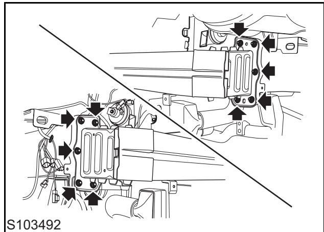
10 拆下 10 个将前保险杠缓冲梁固定到车身前纵梁上的螺母并收集好 10 个垫圈，在协助下，移开前保险杠缓冲梁。
