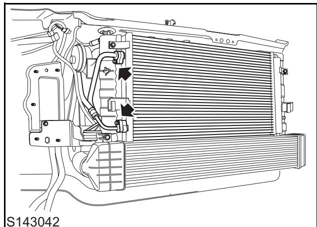
12 分别拆下 2 个将空调管路连接到冷凝器上的螺栓，松开空调管路与冷凝器的连接并废弃空调管路上的 O 型圈。
