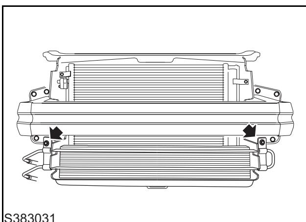
9 拆下 2 个将转向油冷却器固定到前保险杠缓冲梁支架上的螺栓并将转向油冷却器放置在一边。
